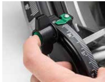
**Die Hinterschnittfunktion (-1°/+46°) ermöglicht präzise Passschnitte.**
